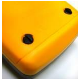
Крепёж крышки батарейного отсека
